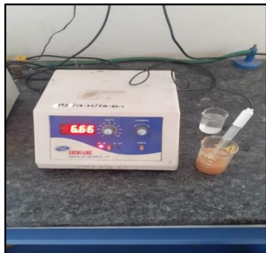
Fig. 15. Digital pH Meter.
